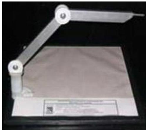
Figura 3- Protótipo da cadeia cinemática do robô manipulador.
