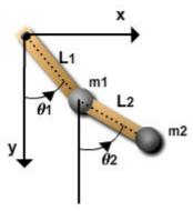
Figura 1. Pêndulo duplo e referenciais adotados.
