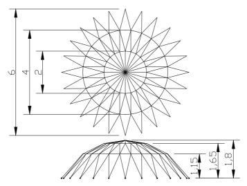
Figura 1 – Exemplo 1: casca treliçada – planta e elevação.
