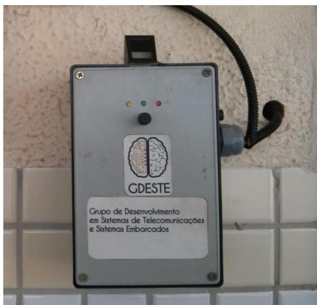
Figura 7 – Versão final do sistema de controle de acesso, na parede de fora do laboratório.
