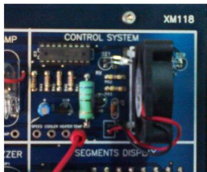
Figura 2: Sistema de Controle Térmico do Kit XM118.
