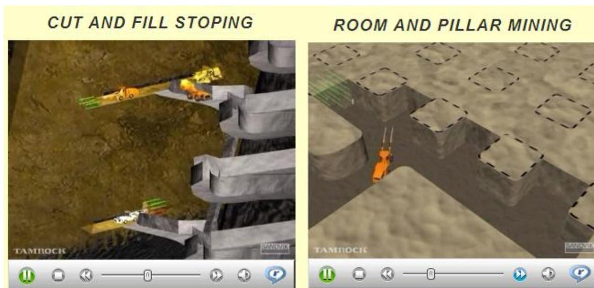
Figura 08 – Exemplo de vídeos dos métodos de Exploração subterrânea de câmaras e pilares (esquerdo) e corte e enchimento (direito) (Website 7)
