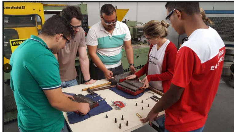
Figura 9: Preparação do molde de injeção realizada por alunos e professores
