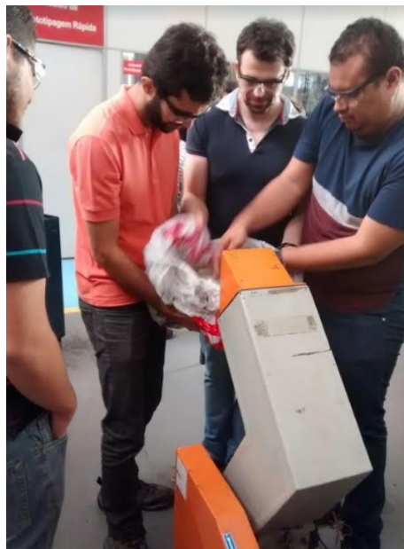
Figura 6: Material sendo inserido no moinho de facas
