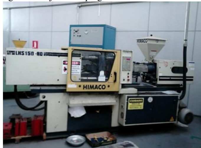
Figura 10: Injetora empregada no desenvolvimento do projeto
