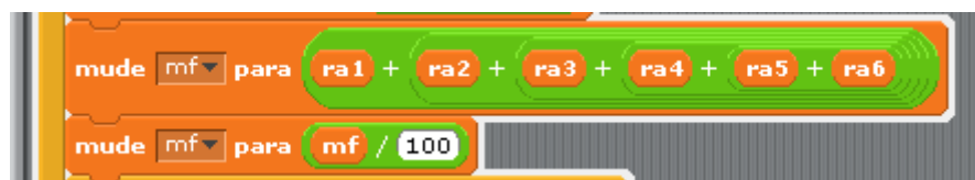
Figura 8: cálculo do módulo de finura da areia
