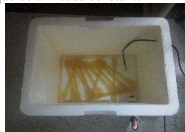
Figura 8 – Instalação do sensor no tanque de umidade constante
